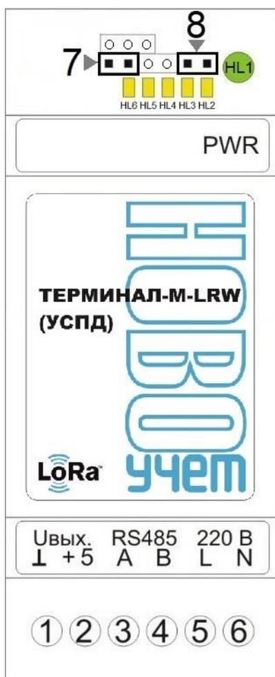
Рисунок 3.1 – Расположение контактов Модуля
