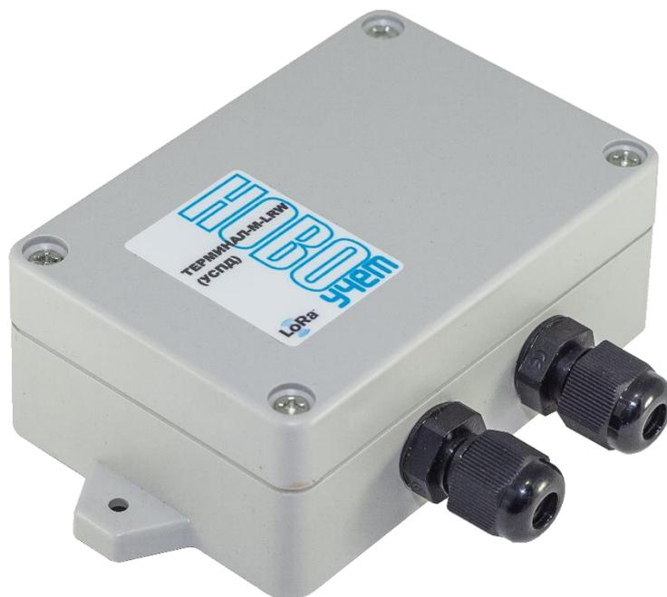
СЧЕТЧИК ИМПУЛЬСОВ 4-КАНАЛЬНЫЙ ТЕРМИНАЛ-M-LRW является устройством сбора и передачи данных беспроводной сети LoRaWAN диапазона 868 МГц и предназначен для подсчета электрических импульсов по каждому входу, либо использования в качестве охранных. Работа в различных режимах возможна благодаря индивидуальной настройке каждого входа.
